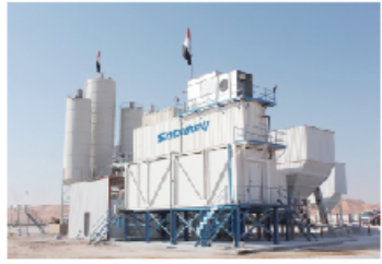
混凝土冷却 (片冰、管冰、冷水)
